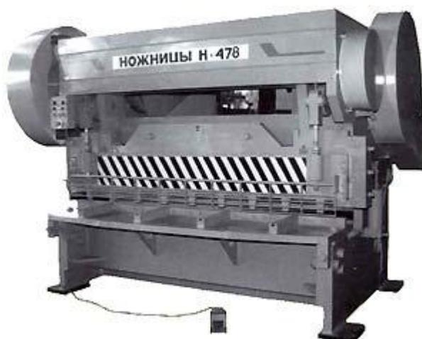
Ножницы Н478 служат для поперечной и продольной резки листа. Резка листового металла производится за один ход ножа по упору, либо разметке. Ножницы используются на открытом воздухе или в закрытых помещениях при температуре воздуха от -20 до +40 градусов.
